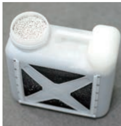
同社が試作したハスクレイ利用および輸送を容易にする専用コンテナ。
