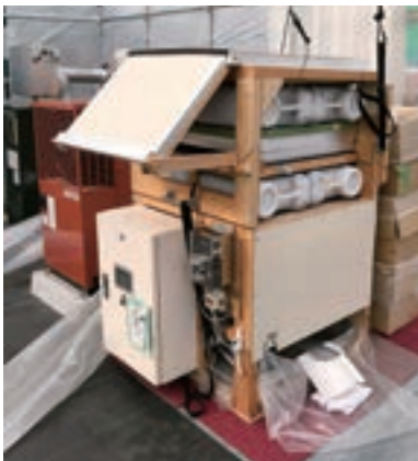
ハスクレイの放熱装置。パイプを通してピンポイントでハウス内の夜間暖房に活用し、使用後は再び温泉へ輸送し蓄熱。
