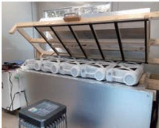
つなぎ温泉で実証実験中の温泉熱を利用した蓄熱装置。
